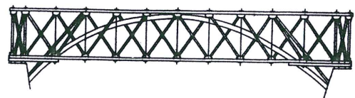
Bild 11a: Zeichnung zum Patent von Howe (1846)
